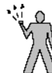
Vpřed – Vodu Zvýšení tlaku Skrčenou paží několikrát vzpažit vzhůru do výše hlavy. Opakování signálu několikrát za sebou znamená žádost o zvýšení tlaku vody
